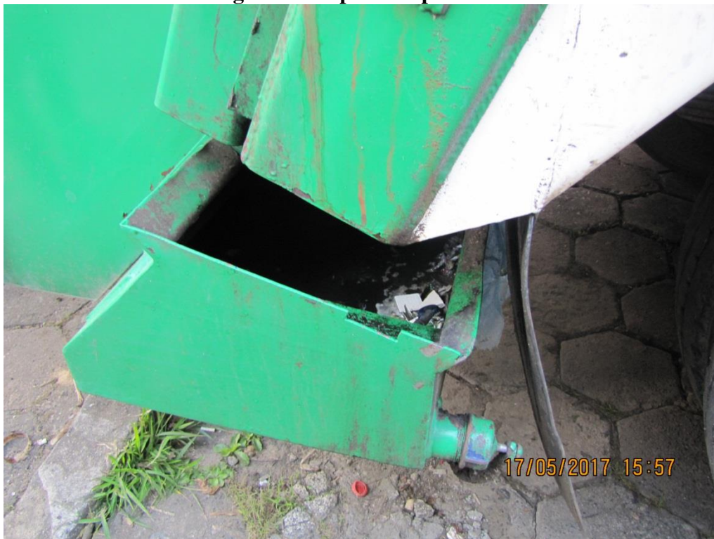
Figura 6 – Detalhe da tampa traseira do veículo dotada de reservatório para coleta de chorume e válvula de esgotamento para limpeza.
