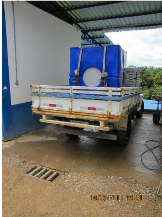
Figura 26 - ETA Central: Vestígio de água de lavação de veículos lançada diretamente em rede de drenagem - não conformidade
