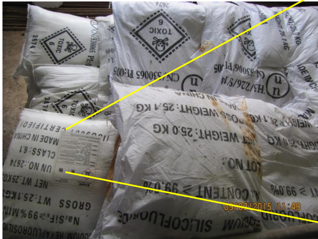
Figura 05 – ETA Central: Ausência de etiquetas com tradução para o português em embalagem de produtos químicos- não conformidade
