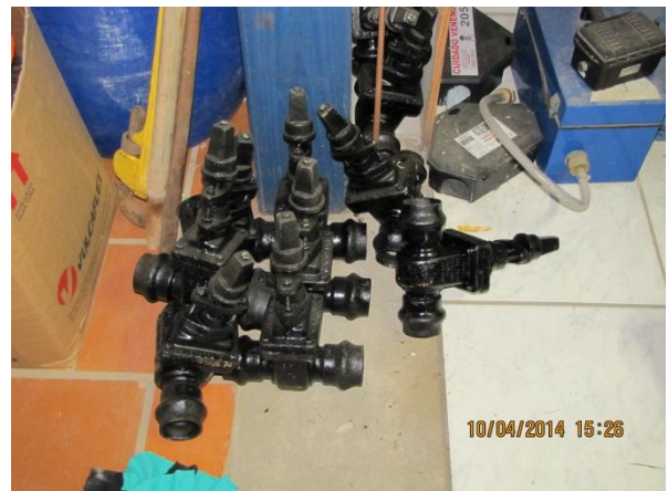
Figura 209 – Almoarifado: Depósito das válvulas em contato direto com o solo podendo ocasionar avarias a pintura de revestimento externo – não conformidade
