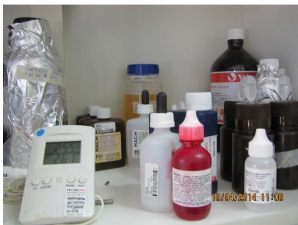
Figura 97 – ETA: Armazenagem dos produtos químicos em boas condições e com controle de temperatura - conformidade
