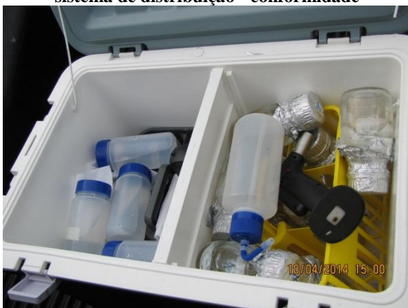
Figura 197 – Rede: Detalhe do acondicionamento das amostras coletadas - conformidade
