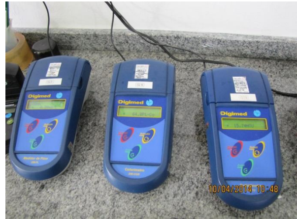
Figura 78 – ETA: Equipamentos para análise laboratorial com etiquetas de controle de calibração dentro do prazo de validade - conformidade
