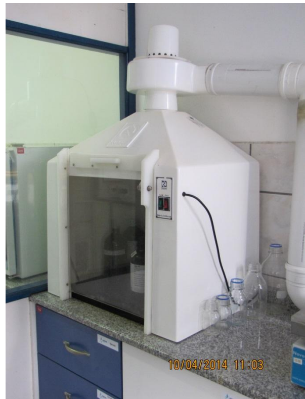
Figura 92 – ETA: Capela laboratorial para manuseio de produtos químicos - conformidade
