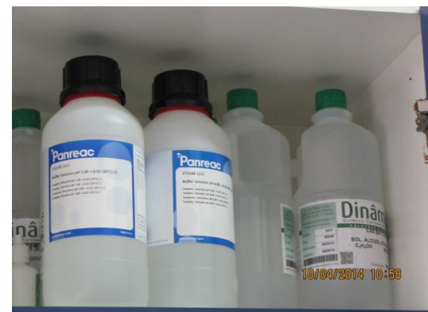
Figura 98 – ETA: Armazenagem dos produtos químicos em boas condições – conformidade. Reagentes estocados com presença de identificação, controle do lote e data de validade - conformidade
